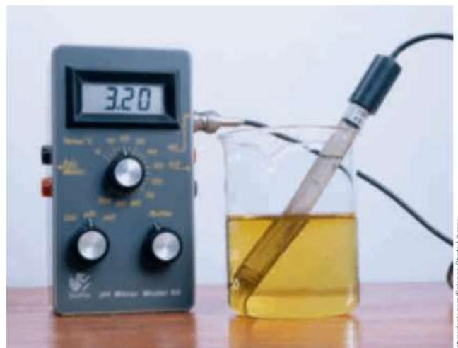
21.1–2 Ein pH-Teststreifen besteht aus einem Papier, das sich unterschiedlich färbt, abhängig davon, ob es in eine basische, neutrale oder saure Flüssigkeit getaucht wird; pH-Meter: Ein pH-Meter zeigt den pH-Wert elektronisch an
