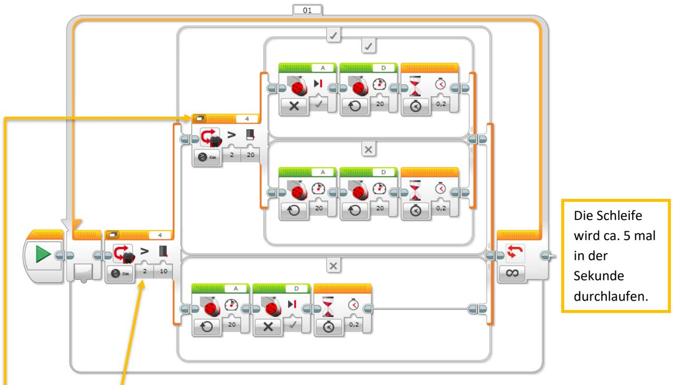
Der 1. Schalter mit dem Ultraschallsensor schalten in den oberen Pfad („wahr“), wenn der Abstand größer als ca. 10 cm ist. Wenn der Abstand kleiner als ca. 10 cm ist („falsch“), wird der untere Pfad mit den Blöcken Motor A mit 20 % der Leistung eingeschaltet und der Motor D ausgeschaltet. Dann wird mit dieser Einstellung 0,2 Sekunden gewartet.
