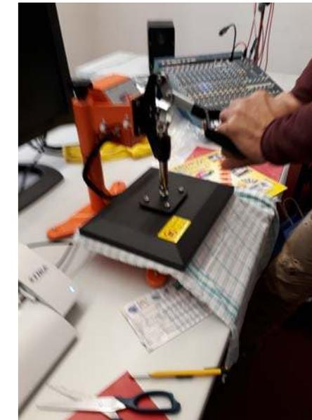
**4. Heizplattenhebel nach unten drücken, bis sie einrastet, dazu muß etwas Kraft zum Einsatz gebracht werden**
