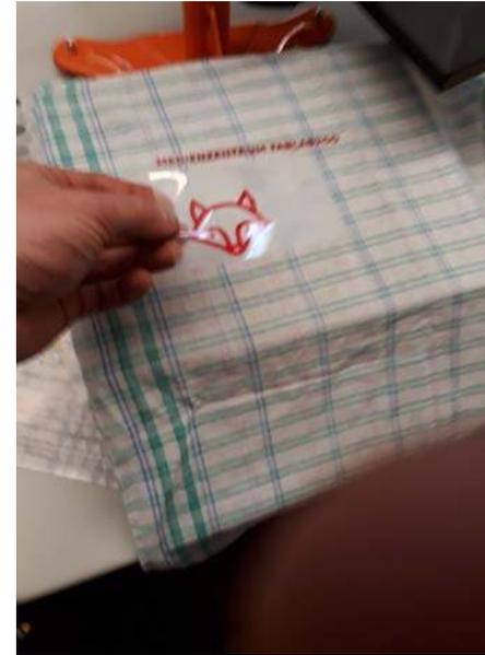
**2. Heizplatte mit dem Hebel auf die Seite drehen, Textil einlegen und entgitterte Grafik auf das Textil legen Die glänzende Folie muß oben sein.**
