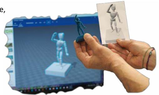
Mit dem **FabLab2Go 3D-Druck** können räumliche Objekte zunächst digital modelliert und anschließend ausgedruckt werden. Dafür stehen ein Laptop mit entsprechender Software samt Beispieldateien und ein 3D-Drucker mit BIO-Filament (=Druckrohstoff) zur Verfügung.
